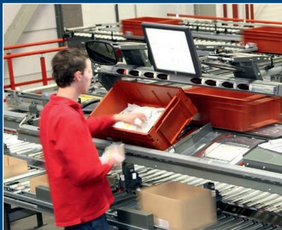
Hinzu kommt eine Auswahl an Bodenvarianten, so dass durch eine Anpassung an die Behälterbelastung eine Durchbiegung des Bodens und daraus resultierende Störungen der Förderanlage ausgeschlossen werden können.
